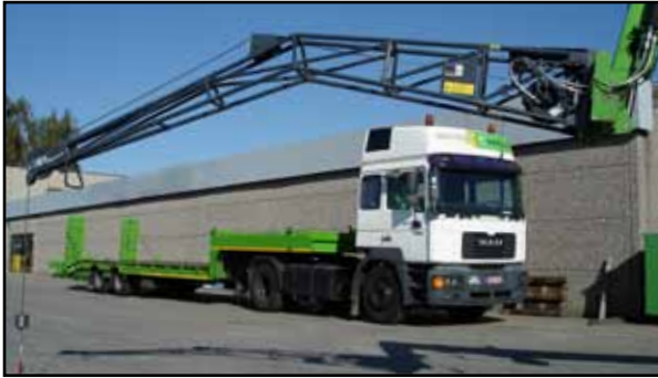
Gitterausleger 4 m & Seilwinde 400 kg
