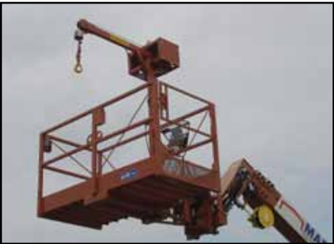
Sonderbühne 2,5 m, abnehmbare Seilwinde 500 kg
