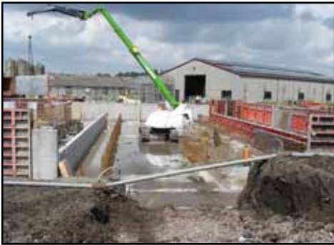
Hakenausleger 3,5 m & Seilwinde 900 kg
