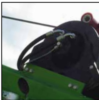
Seilwinde 4 Ton unten am Mast
