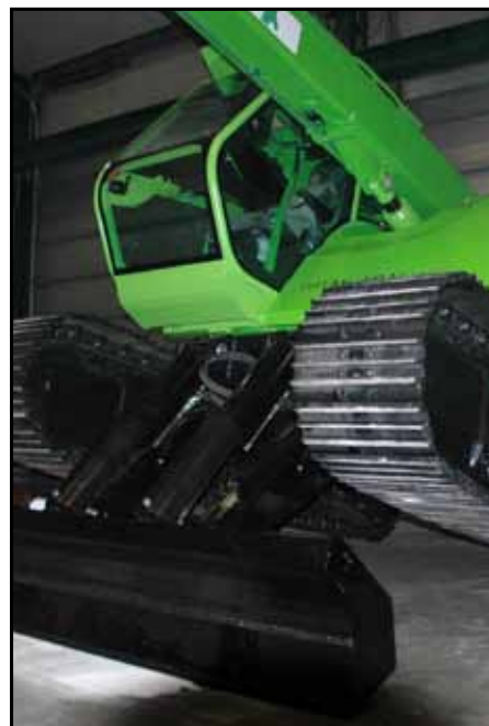
VBLADE Stützschild ermöglicht die Arbeit in schrägen Hanglagen bis zu 19° (34%)
